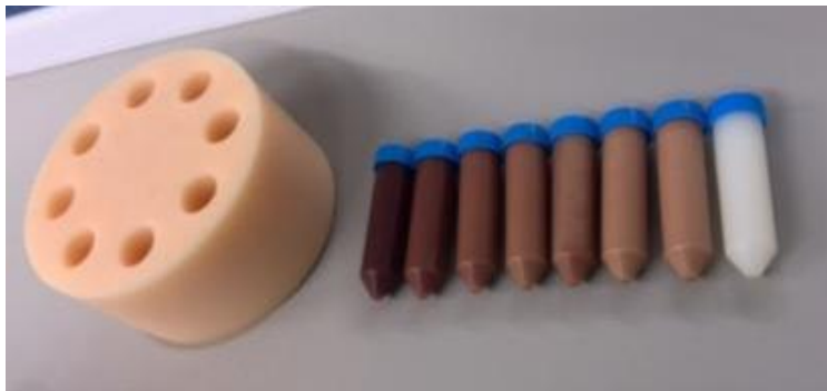
Figure 1. ブタ肝とラードを利用した脂肪密度検証用ファントム
